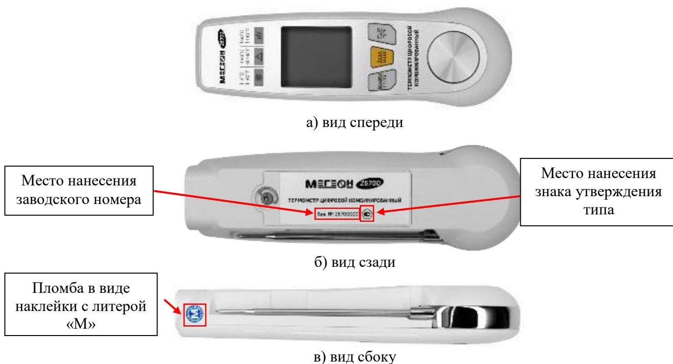
Рисунок 2 – Общий вид термометров модификации МЕГЕОН 26700 с указанием места ограничения доступа к местам настройки (регулировки), места нанесения знака утверждения типа, места нанесения заводского номера
