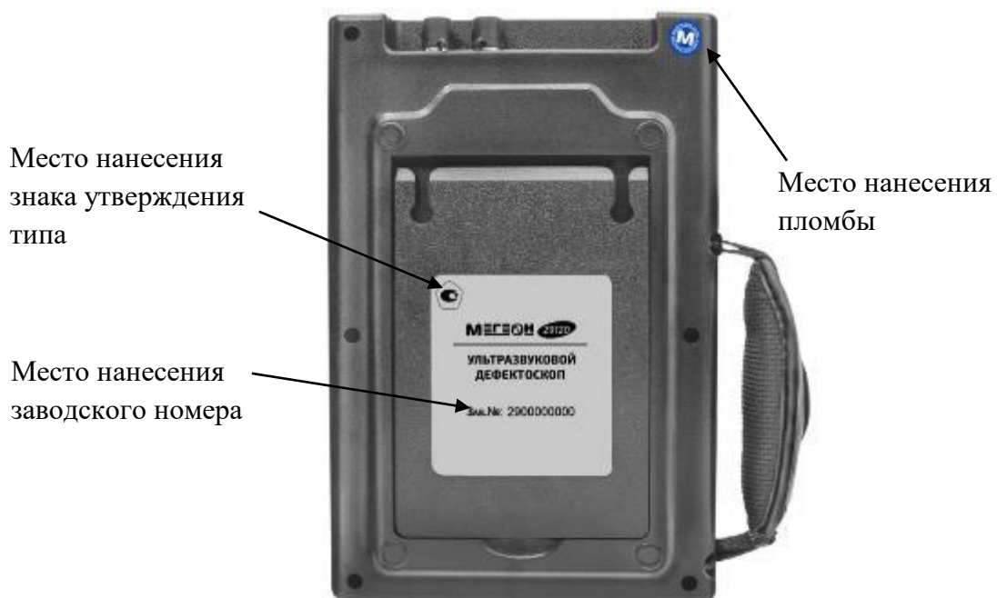
Рисунок 4 – Место нанесения заводского номера, знака утверждения типа и пломбы на дефектоскопы модели 29120
